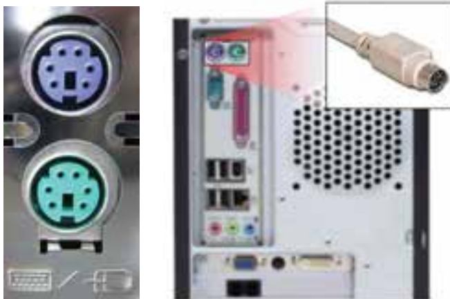
شکل ۲۳-۶ محل اتصال رابط های PS/2 صفحه کلید (رنگ بنفش) و ماوس (رنگ سبز)
