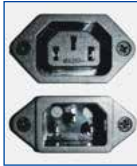
شکل ۵-۷ ورودی برق شهر برای منبع تغذیه و خروجی تأمین برق صفحه نمایش
