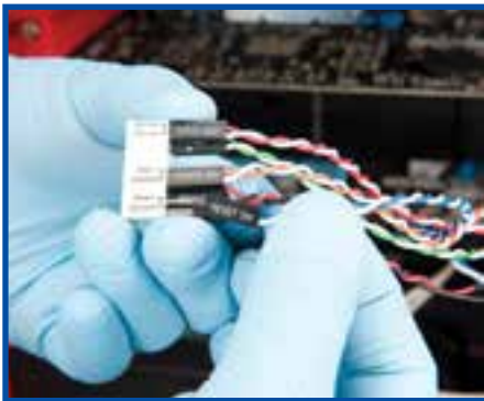
شکل ۱۹-۸ نصب و اتصال کانکتورهای پانل جلوی کیس
