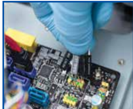
شکل ۱۹-۸ نصب و اتصال کانکتورهای پانل جلوی کیس
