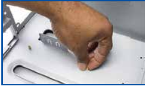
شکل ۸-۱۲ ثابت کردن پایه‌های برنجی
