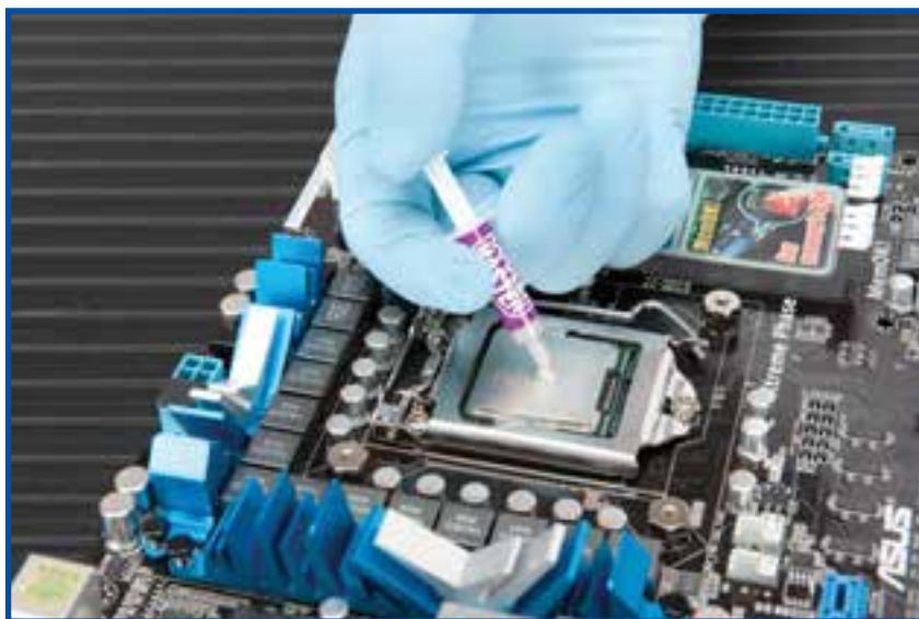
شکل ۷-۸ پوشاندن پردازنده با خمیر انتقال حرارت
