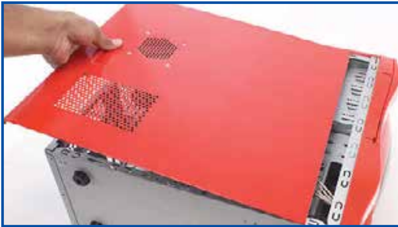
شکل ۸-۱ برداشتن قاب‌های جانبی
