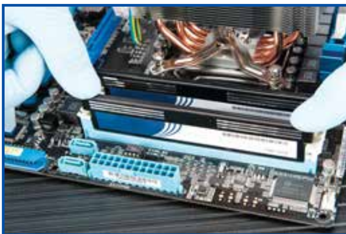
شکل ۱۱-۸ استقرار ماژول حافظه در شکاف حافظه
