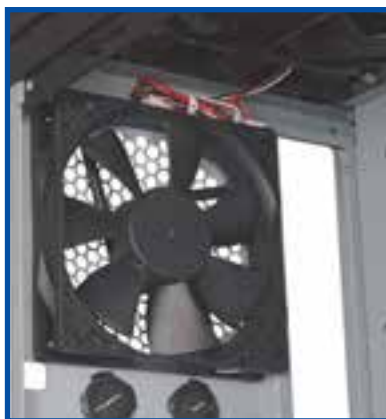
شکل ۳-۸ نصب پروانه خنک‌کننده کیس
