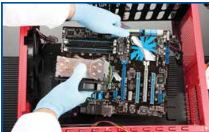
شکل ۸-۱۴ نصب برد اصلی
