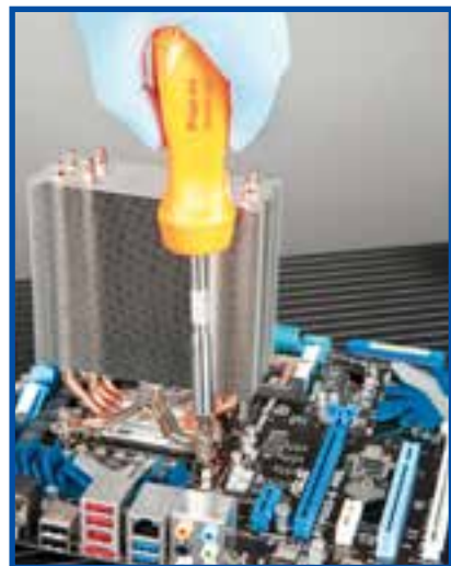
شکل ۸-۸ نمونه‌ای از نصب پایه خنک کننده
