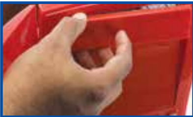
شکل ۲۰-۸ برداشتن پانل جلوی کیس
