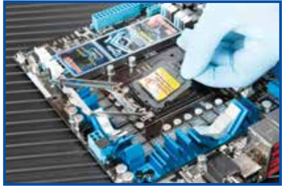
شکل ۴-۸ برداشتن پوشش محافظ سوکت پردازنده
