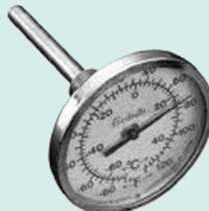
شکل ۱۰-۲- دماسنج بی‌متال
