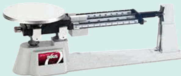
شکل ۲-۵- ترازوی یک کفه‌ای سه اهرمی ۸ (مکانیکی)
