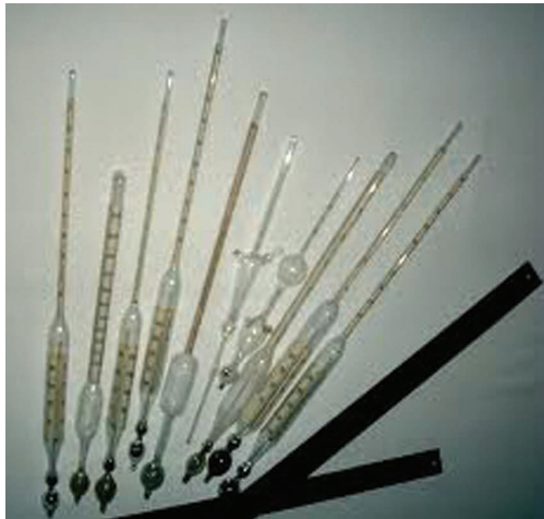
شکل ۵–۸ انواع هیدرومتر
