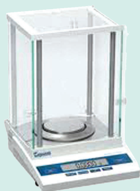
شکل ۴-۵- ترازوی یک کفه‌ای الکتریکی ۲ (دیجیتالی)
