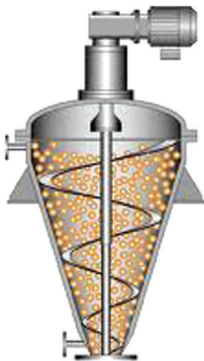
شکل ۱۰-۱۱ - مخلوط‌کن ماریچ عمودی
