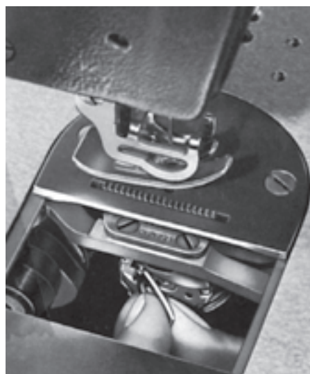
شکل ۴۸- الف - طریقه برداشتن ماکو از زیر چرخ
