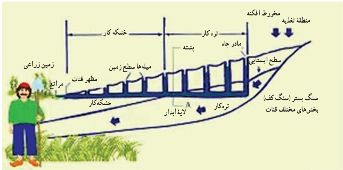
شکل ۳۱-۳- شمای یک قنات
