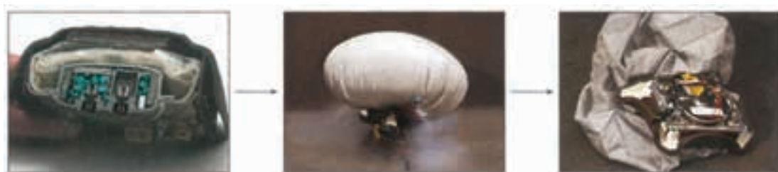
شکل ۱۹ – گاز نیتروژن آزاد شده از واکنش‌های شیمیایی درون چاشنی سبب پر شدن کیسه هوا می‌شود.
