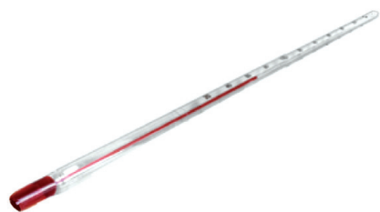
شکل ۱۸-۲ دماسنج دارای حباب مایع دار (دماسنج جیوه‌ای)
