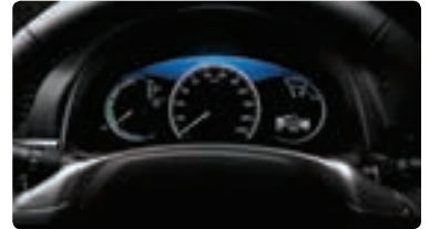
شکل ۲-۹- سرعت سنج خودرو در هر لحظه، اندازه سرعت لحظه‌ای را نشان می‌دهد.
