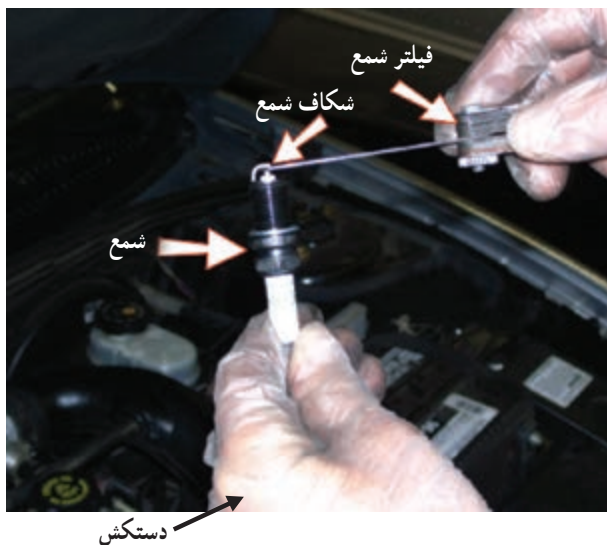
شکل ۲-۵۸- استفاده از دستکش و ابزار صحیح از ضروریات اجتناب ناپذیر برای اجرای کار صحیح است
