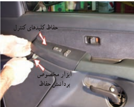
شکل ۲-۶۱- هنگام بازکردن قسمت‌های پلاستیکی و تزئیناتی مراقب باشید به آن‌ها آسیبی وارد نشود.
