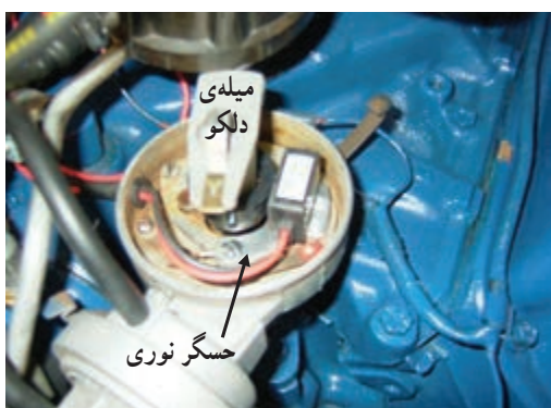
شکل ۱۴۵-۲- سه نمونه حسگر استفاده‌شده در سیستم جرقه‌زنی
