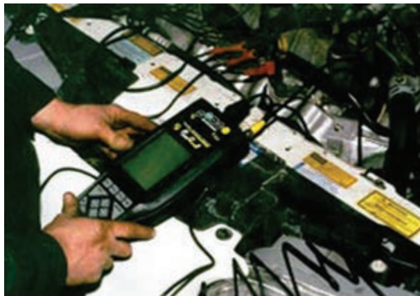
شکل ۱۹۴-۲- یک نمونه دستگاه اسکنر کوچک دستی
