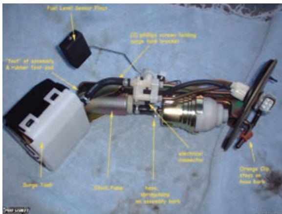
شکل ۲-۱۸۲- یک نمونه حسگر سطح سوخت قدیمی
