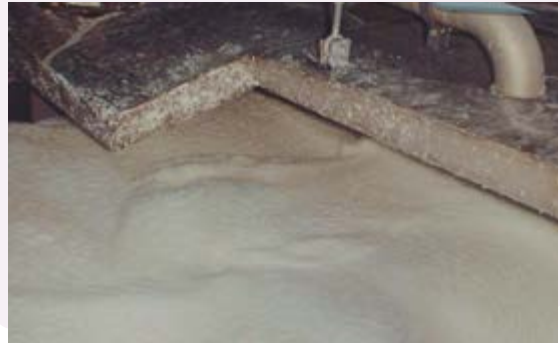
(۵) تبدیل چپس چوب به خمیر و از بین بردن رنگ آن
