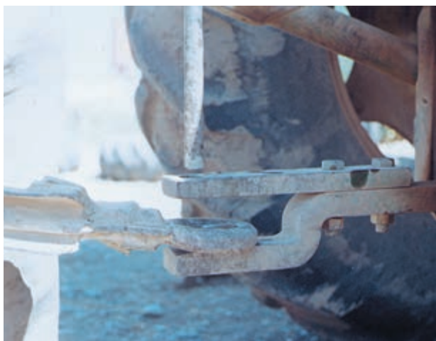
شکل ۳۶-۱ باز کردن پی نورد از تراکتور
