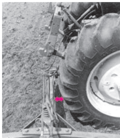
شکل ۳۵-۱ زاویه تند بین مالبندها تراکتور و پی نورد
