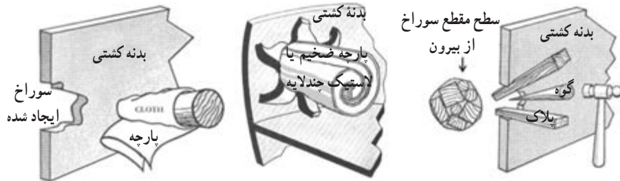
شکل ۵-۱۰- انواع گوه و نحوه مسدود کردن سوراخ به‌وسیله پلاک، گوه و پارچه
