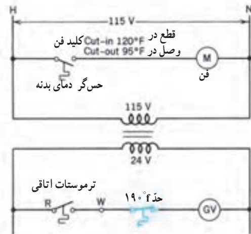
الف) کوره با ترموستات در مدار شیر گاز
