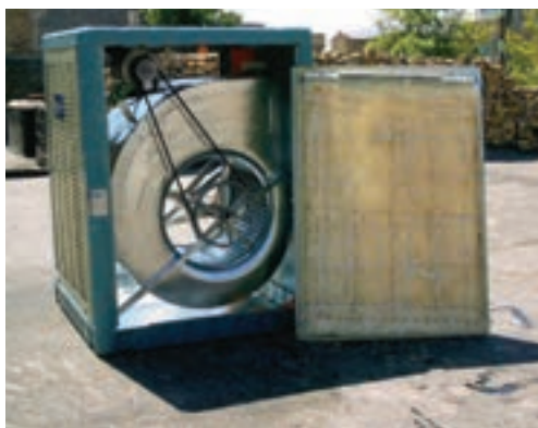
شکل ۱۳-۱۱- ساختمان اتاقک یک کولر
