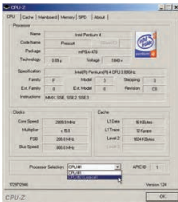
شکل ۶-۳ نمایش مشخصات پردازنده با نرم افزار CPU-Z
