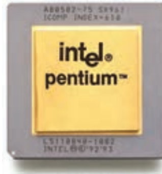
شکل ۲۸-۳ پردازنده پنتیوم ۷۵ و سوکت شماره ۵
