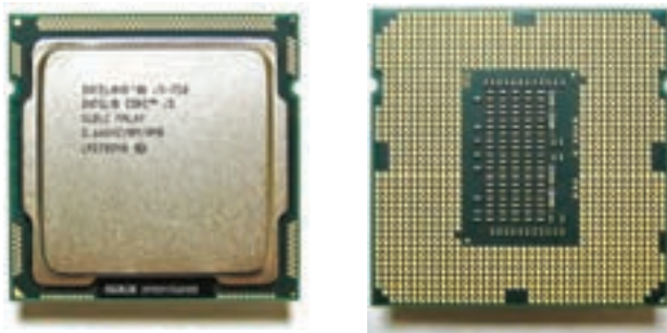
شکل ۳-۴۰ جلو و پشت پردازنده Intel Core i5-750
