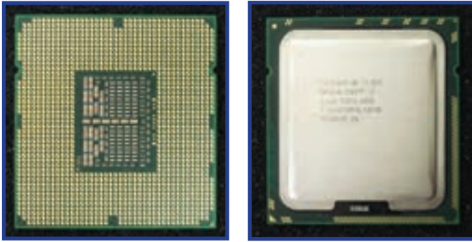
شکل ۳۷-۳ جلو و پشت پردازنده Intel core i7-975
