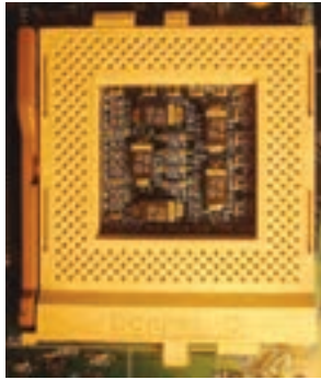
شکل ۲۸-۳ پردازنده پنتیوم ۷۵ و سوکت شماره ۵
