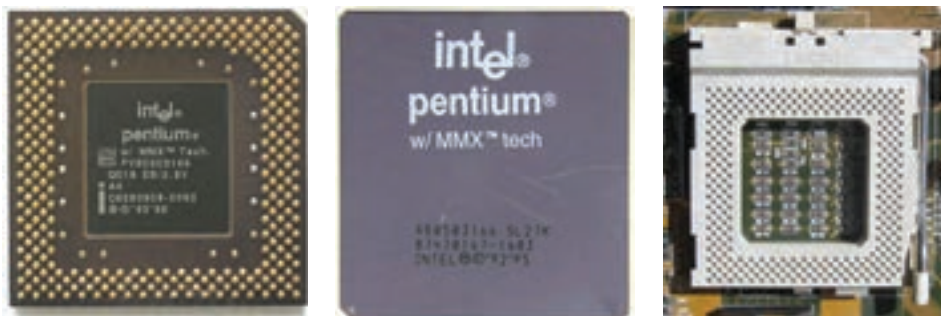
شکل ۲۹-۳ پشتهای جلو و پشت پردازنده پنتیوم MMX ۱۶۶ و سوکت شماره ۷
