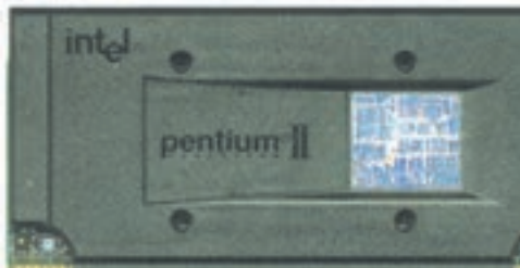
شکل ۳۱-۳ جلو و پشت پردازنده پنتیوم II با دو تراشه حافظه نهان و به صورت شکاف ۱
