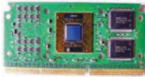
شکل ۳۱-۳ جلو و پشت پردازنده پنتیوم II با دو تراشه حافظه نهان و به صورت شکاف ۱
