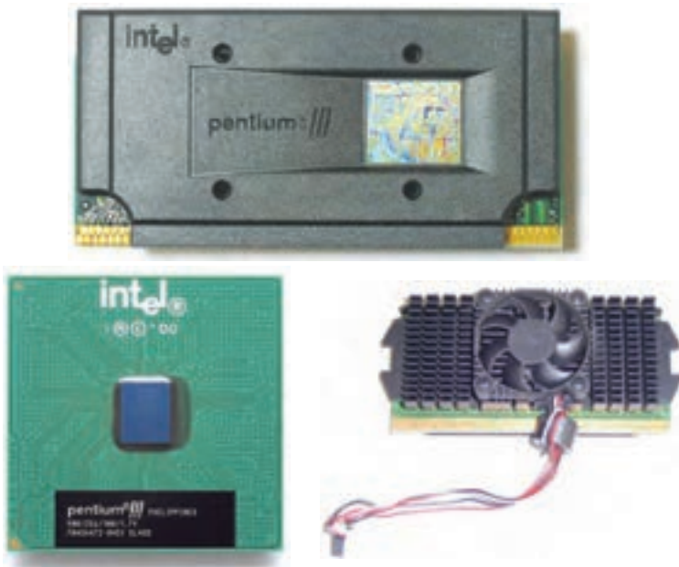
شکل ۳-۳۳ پردازنده پنتیوم III با ساختار شکاف ۱ (بالا)، پروانه خنک کننده آن و پنتیوم III با شکل کلاسیک (پایین)
