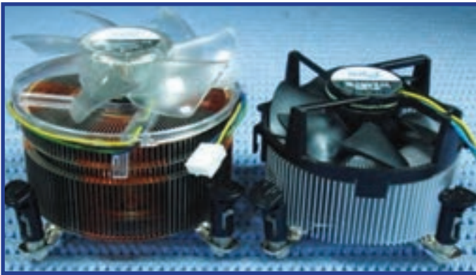
شکل ۳۸-۳ نمونه‌ای از سیستم خنک کننده پردازنده‌های core i7
