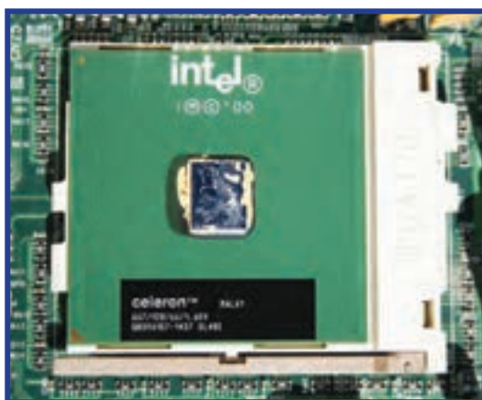
شکل ۳۲-۳ پردازنده سلرون و سوکت ۳۷۰ PGA
