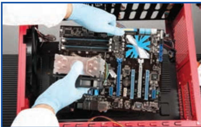
شکل ۸-۱۴ نصب برد اصلی
