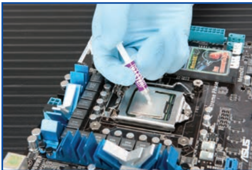
شکل ۷-۸ پوشاندن پردازنده با خمیر انتقال حرارت
