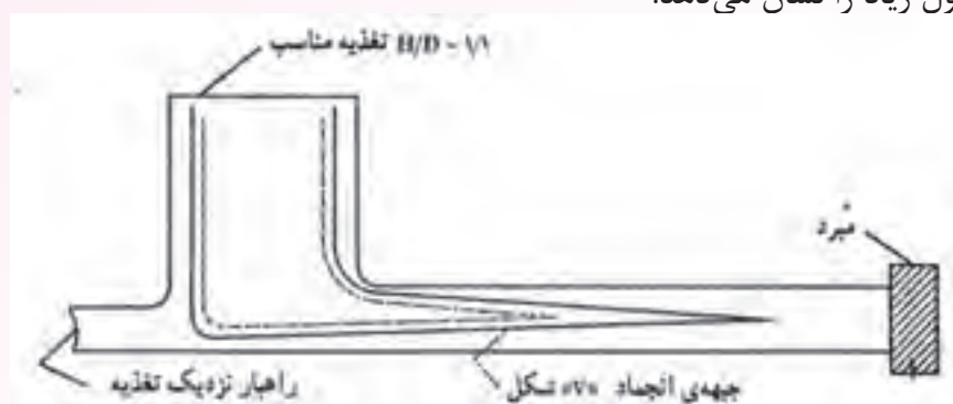
شکل ۴-۶. انجماد جهت‌دار در آلیاژهای با انجماد پوسته‌ای مُبرد
