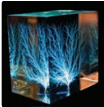
شکل ۱-۳۰ فروریزش الکتریکی باعث تشکیل مسیرهای رسانشی سرخس شکلی در دی الکتریک شده است.
