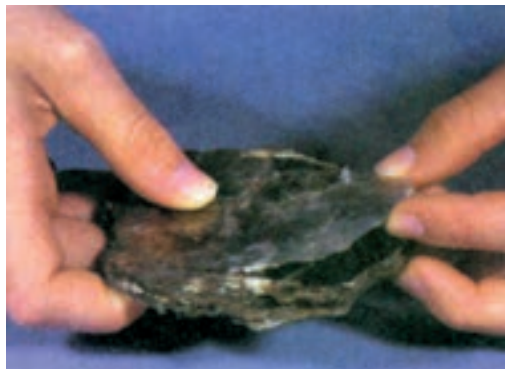
شکل ۱۱-۵- ساختمان ورقه‌ای در میکا
