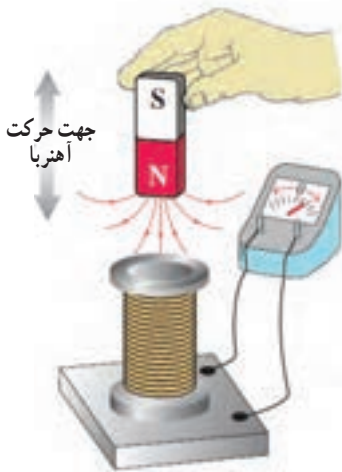
شکل ۱-۴ با حرکت آهنربا به طرف سیمولوله یا پیچه گالوانومتر جریان القایی را نشان می‌دهد.
