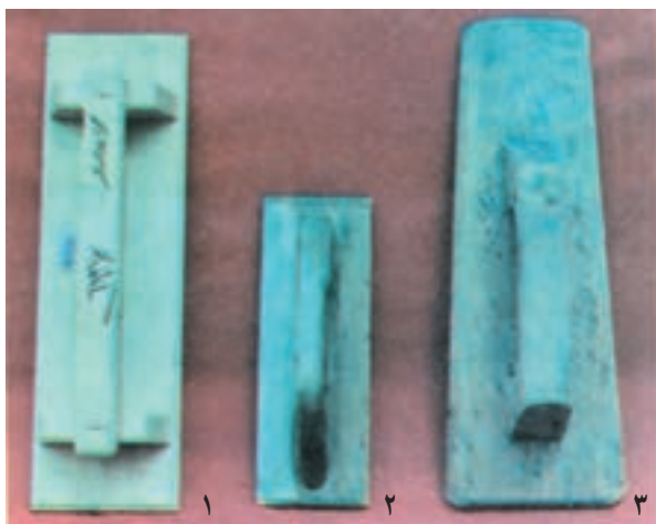
۱- تخته ماله ی کوبنده ۲- تخته ماله ی معمولی ۳- تخته ماله ی کوچک پرداختی بهتر است از جنس انعطاف پذیر باشد (پلاستوفوم).
