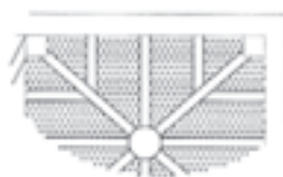
شکل ۶-۸ - جزئیات A، نحوه‌ی تقسیم بندی کُرم‌ها و ریختن بتن پوکه بین آن‌ها
