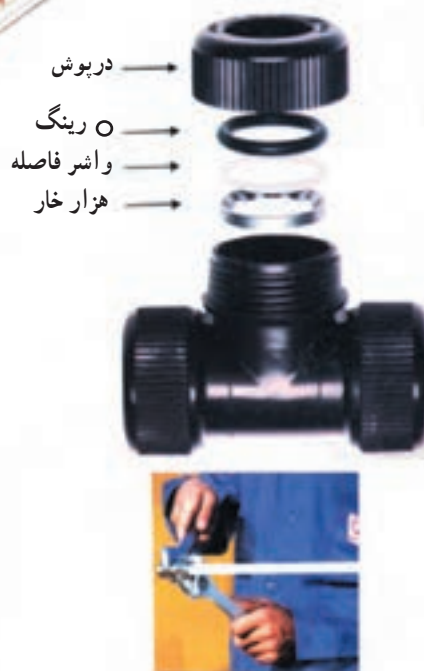
شکل ۴-۸- نمونه‌هایی از مصرفر پلیاستیک در ساختمان
