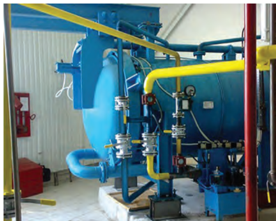
شکل ۱۲- سیستم زمستانه کردن روغن ها
