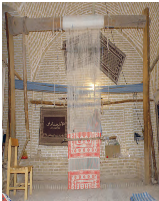
شکل ۲۲-۱ دار چوبی و ثابت برای بافت زیلو
