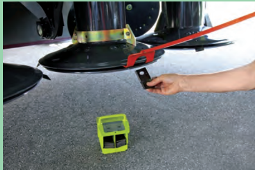
شکل ۲۰- نحوه تعویض تیغه در دروگر استوانه‌ای
