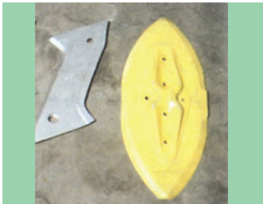
شکل ۴۸- شکل تیغه‌های بیضی و Z شکل
