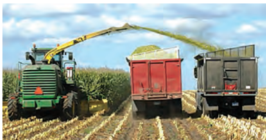
شکل ۴۴- برداشت ذرت به وسیله چابر خودگردان
