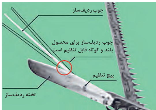
شکل ۳۴- تنظیم صفحه و میله ردیف‌ساز در دروگر شانه‌ای
