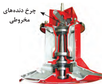
شکل ۴- شماتیک داخلی جعبه دنده و محور اصلی استوانه‌ها و سینی زیر دروگر استوانه‌ای
