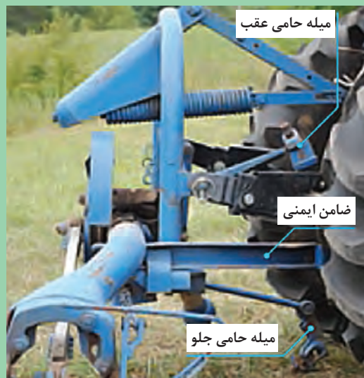
شکل ۲۱- نحوه اتصال دروگر شانه‌ای به تراکتور
