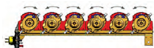
شکل ۸- جهت چرخش بشقاب‌ها در دروگر بشقابی
