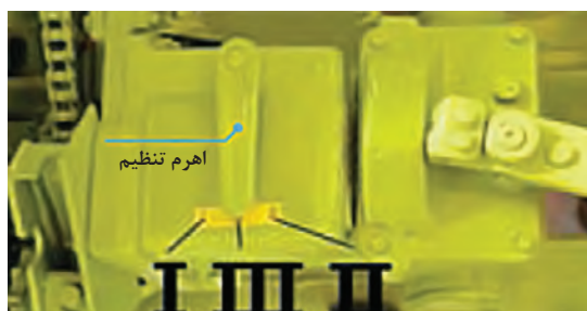
I: باردهی آرام II: باردهی متوسط III: باردهی سریع شکل ۵۲- جعبه دنده تنظیم سرعت باردهی غلتک‌های تغذیه
