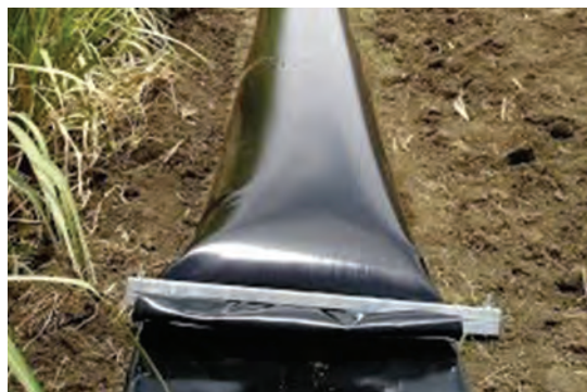
شکل ۱۱- لوله هیدروفلوم با گیره انتهایی
