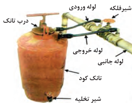
شکل ۲۸- اجزای سیستم توزیع کود
