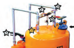
شکل ۲۷- اتصال مخزن کود به لوله اصلی
