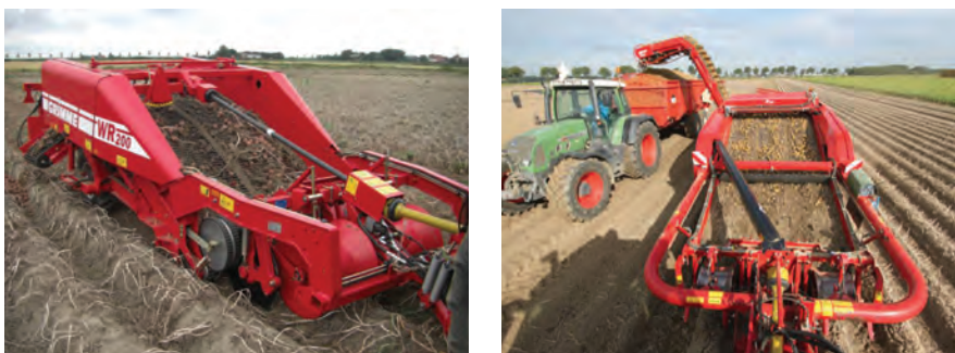
شکل ۲۷- برداشت سیب‌زمینی با دستگاه کمباین
