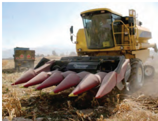
شکل ۱۲- کمباین دارای هد مخصوص برداشت ذرت دانه‌ای
