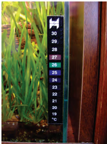
نصب دماسنج روی آکواریوم
