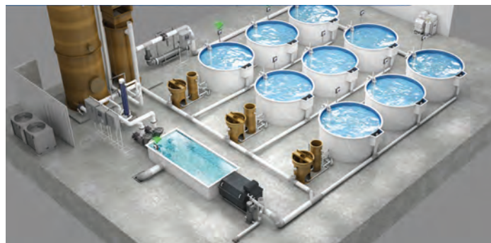
سیستم چرخش آب در پرورش ماهی
