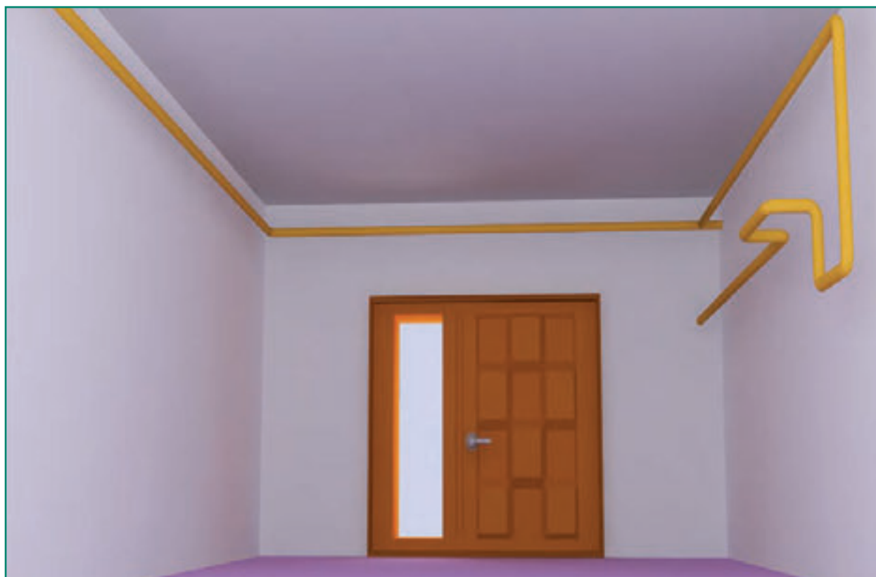
شکل ۴-۲۳ الف نمایش مسیر لوله‌ها در داخل راهرو
