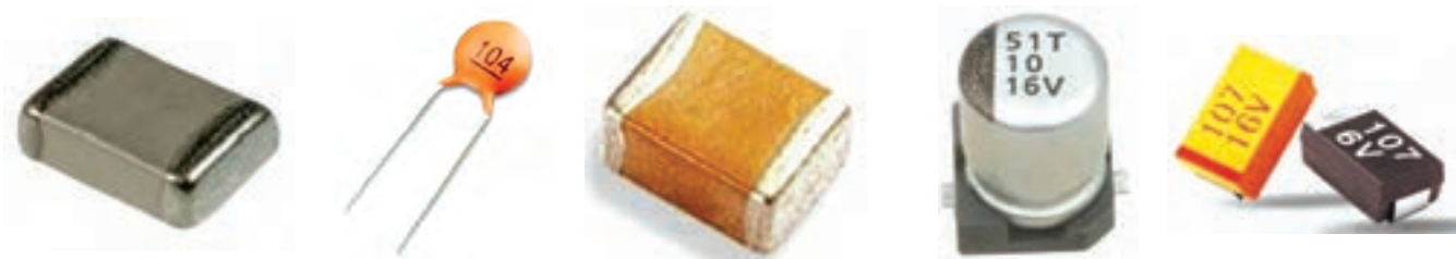
شکل ۱-۲۳ خازن سرامیکی SMD و معمولی
