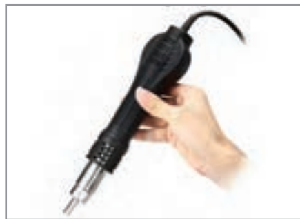
شکل ۷-۱ چگونگی صحیح در دست گرفتن هویه
