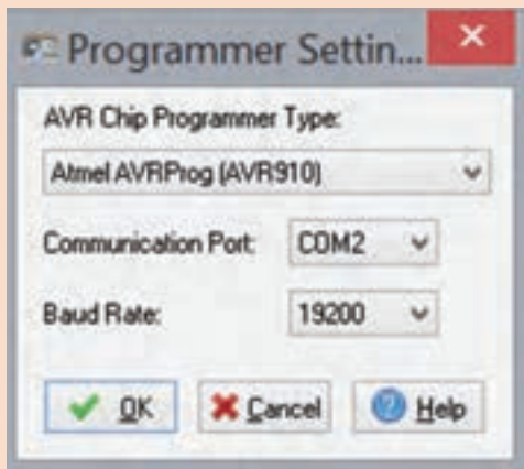
شکل ۷-۲۱ تنظیم پورت و سرعت پروگرامر AVR ۹۱۰
