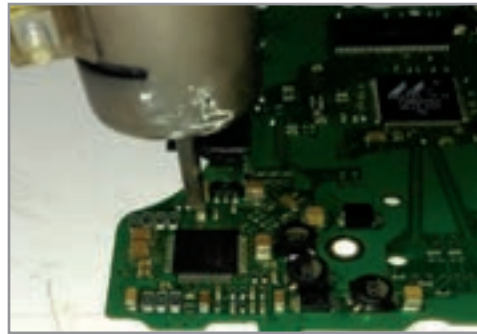
شکل ۲-۴ دمونتاز آی سی های چهار طرفه (خرچنگی)
