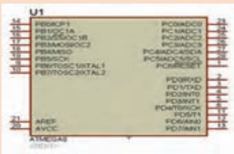
شکل ۶-۲۲ ترسیم نقشه شکل ۶-۲۰ با ATMEGA ۸
