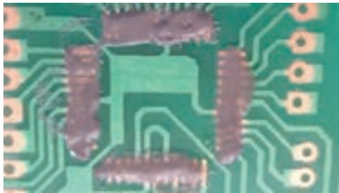
شکل ۹-۳ قرار گرفتن خمیر قلع روی تمامی پدها
