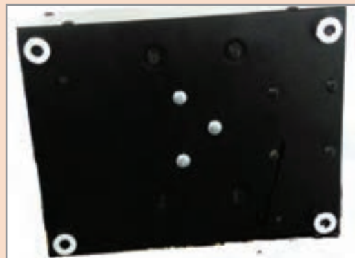
شکل ۱-۴ سه پیچ قفل کننده کمپرسور به بدنه
