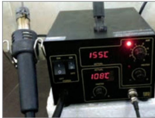
شکل ۱-۱ یک دستگاه هویه هوای گرم
