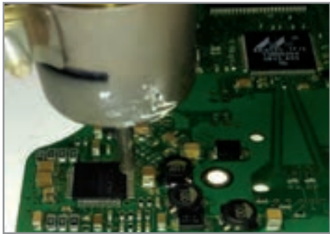
شکل ۲-۴ دمونتاز آی سی های چهار طرفه (خرچنگی)
