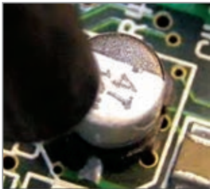
شکل ۲-۳ دمونتاز خازن سرامیکی و الکتrolیت SMD
