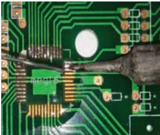
شکل ۳-۵ قلع اندود کردن محل پایه ها با هویه و سیم لحیم
