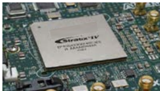
شکل ۲۳-۵ کاربرد آی‌سی FPGA در مدارهای پیشرفته
