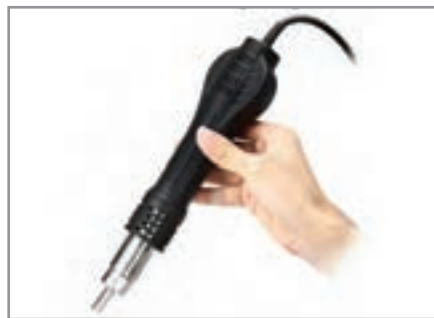
شکل ۷-۱ چگونگی صحیح در دست گرفتن هویه
