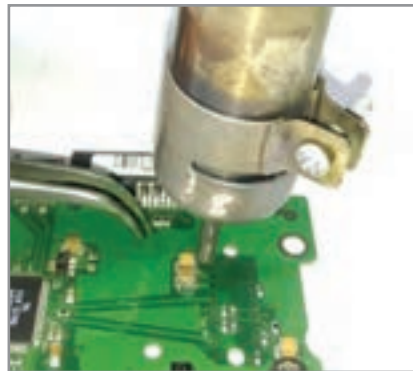
شکل ۲-۳ دمونتاز خازن سرامیکی و الکتrolیت SMD
