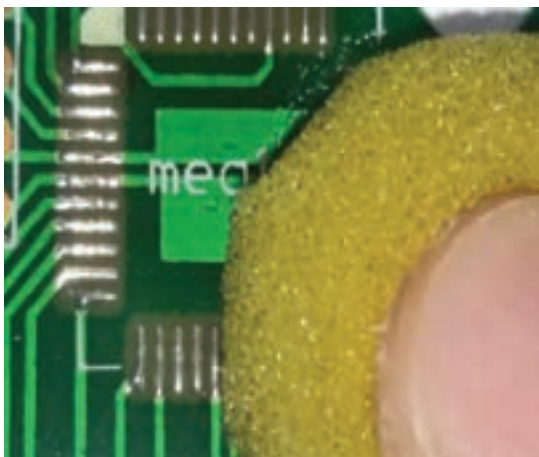
شکل ۳-۶ پاک کردن سطح زیر قطعه به کمک ابرهای اسفنجی
