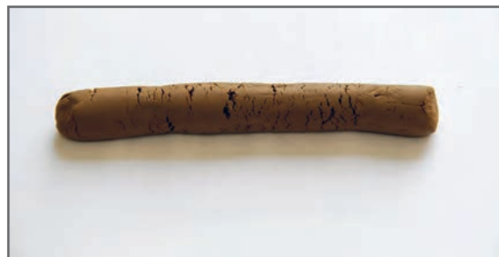
گل با شکل‌پذیری نامناسب - دارای ترک
