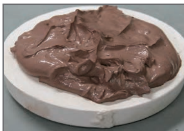
الف - گل پخش شده روی سطح گچ
