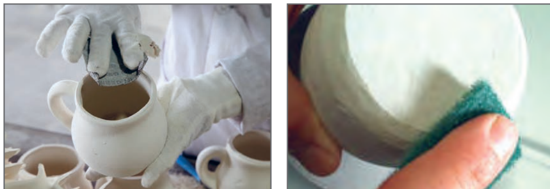
شکل ۹ - پرداخت خشک قطعه با اسکاچ و سنباده
