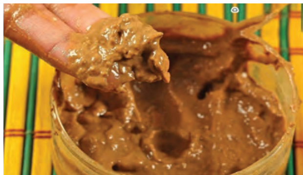
شکل ۵۵- بنتونیت آب جذب کرده و متورم شده
