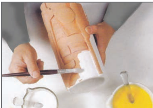
شکل ۱۱- اعمال لعاب بر روی سطح بیرونی قطعه
