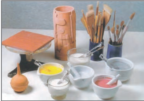
شکل ۱۰- تجهیزات مورد استفاده جهت لعاب‌زنی با قلم‌مو
