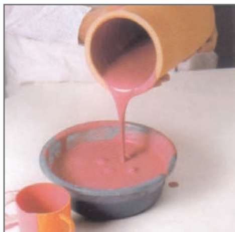
خارج کردن اضافی لعاب از داخل قطعه
