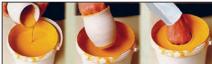
شکل ۱۹- لعاب‌زنی دستی و کارگاهی
