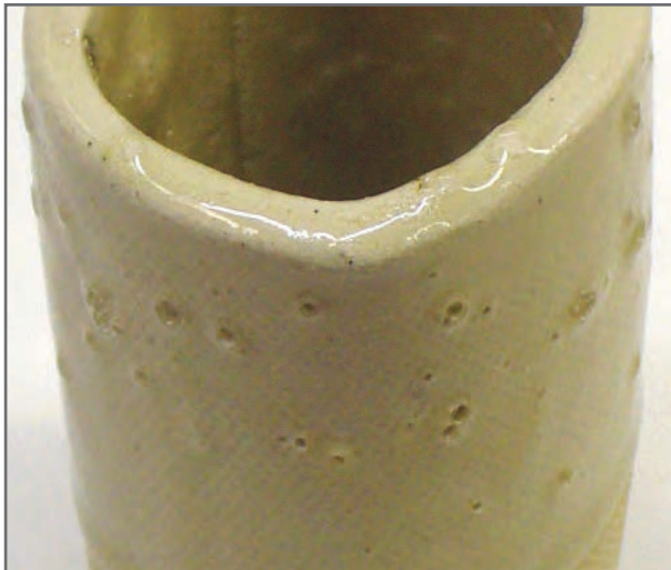
شکل ۳۴- عیب تاول زدن لعاب
