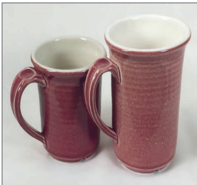
شکل ۲۵- لعاب با دمای پخت نامناسب
