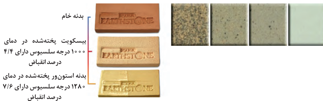
شکل ۵۱- انقباض و متراکم شدن بدنه
