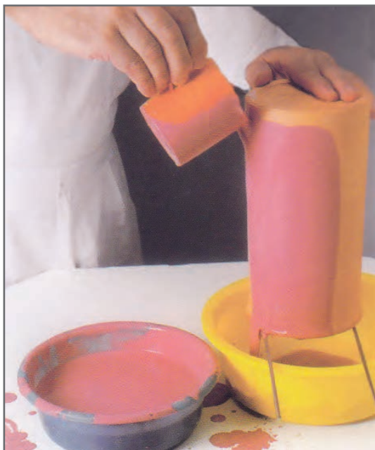
شکل ۱۴- اعمال لعاب به روش ریختنی
