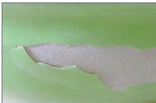
شکل ۲۷- عیب پوسته شدن لعاب
