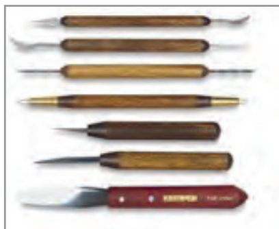
شکل ۱۰- ابزارهای برشی برای ایجاد نقش بریده
