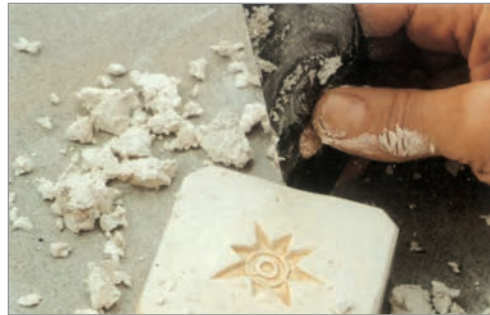
شکل ۱۲- تراشیدن طرح بر روی قالب گچی
