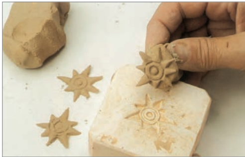
شکل ۱۳- فشار دادن مقداری گل درون قالب
