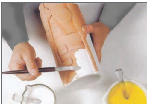
شکل ۱۱- اعمال لعاب بر روی سطح بیرونی قطعه
