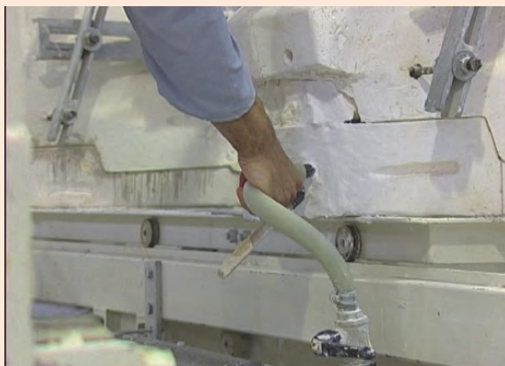
شکل ۲۵- مجرای زیر قالب جهت تخلیه دوغاب
