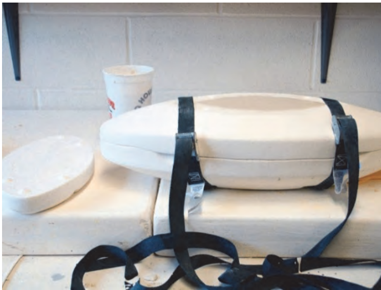
شکل ۱۵- روش‌های مختلف بستن قالب
