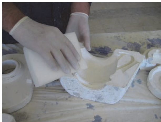
شکل ۴- زدودن گرد و غبار از قالب
