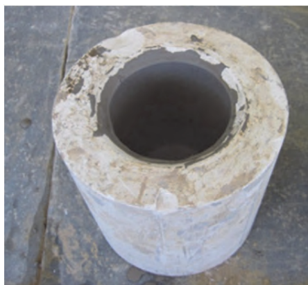
شکل ۹- قالب نمونه برای تعیین سرعت ریخته‌گری
