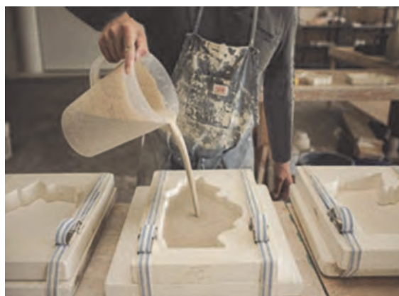
الف) ریخته‌گری دوغابی به روش دستی
