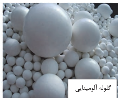
شکل ۱۸- گلوله‌های آلومینایی و فلینتی بال‌میل
