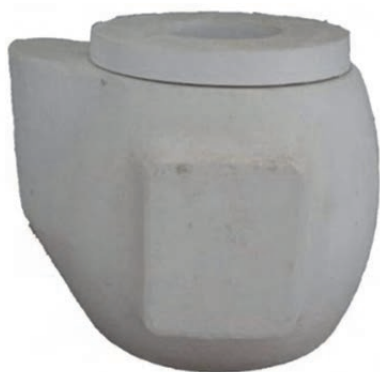
شکل ۲۷- قالب قوری درزبندی شده
