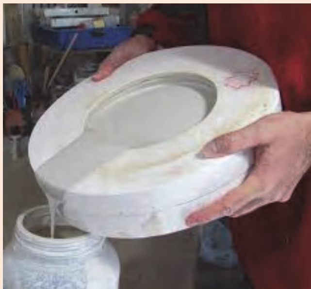
شکل ۱۵- تخلیه قالب
