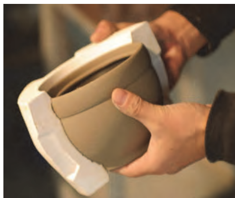
الف- خارج کردن بدنه ریخته‌گری شده
