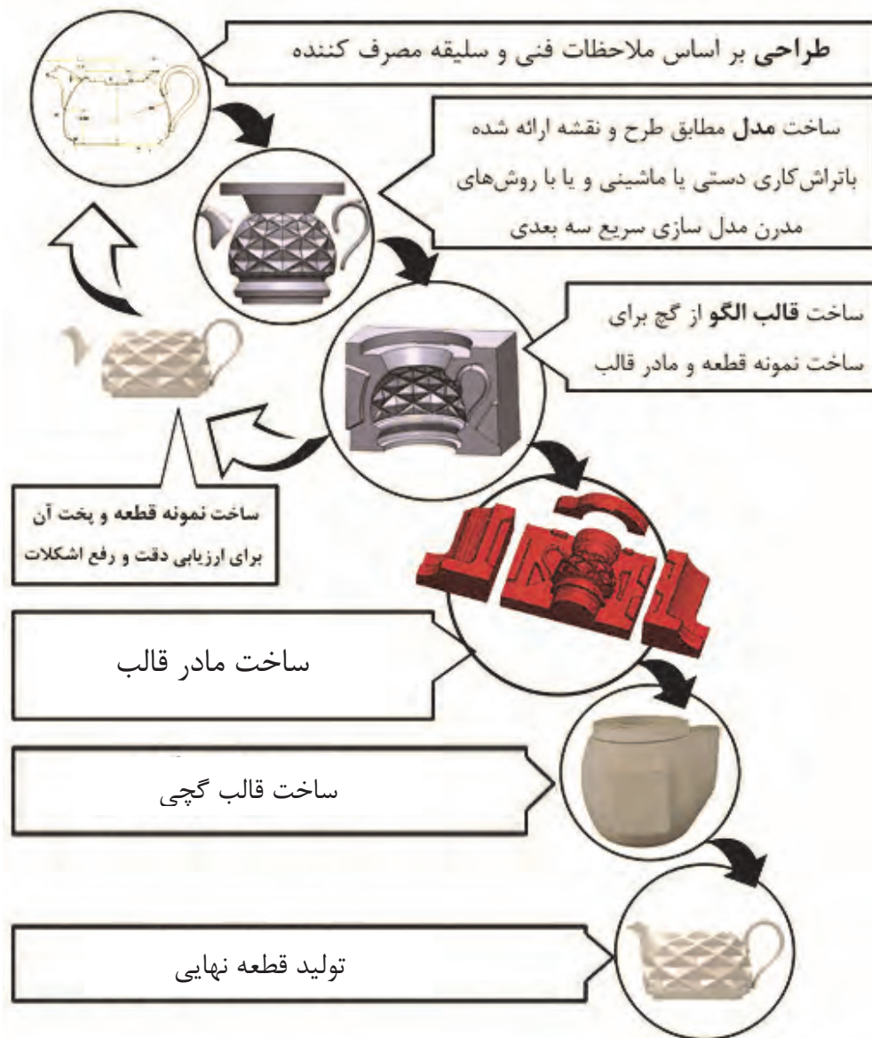
شکل ۶- مراحل ساخت قطعه سرامیکی
