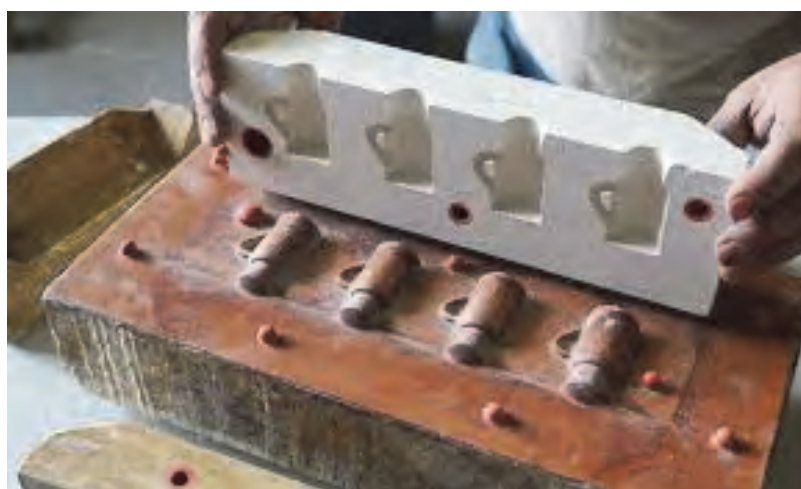
شکل ۴- قالب گچی با قابلیت ریخته‌گری چهار قطعه
