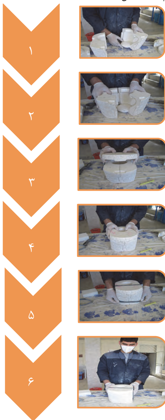
شکل ۷- مراحل بستن قالب
