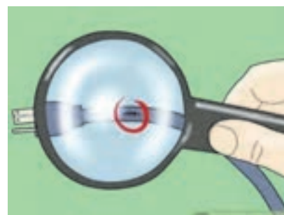
الف) پارگی پوشش سیم تغذیه
