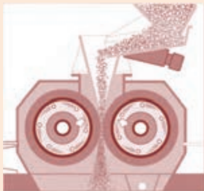
شکل ۳۰- جهت چرخش استوانه‌ها در سنگ شکن غلتکی
