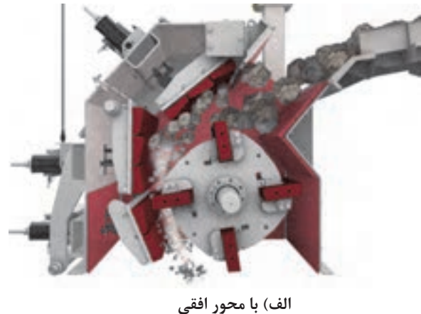
شکل ۳۲- سنگ شکن نوع پرتابی
