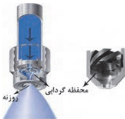
شکل ۲۵- افشانک نازلی نوع گردابی
