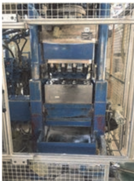
شکل ۱۳- پرس ایزواستاتیک گلوله آلومینایی
