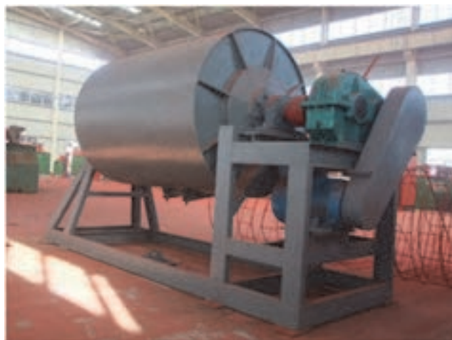
شکل ۱۱- بال میل ناپیوسته
