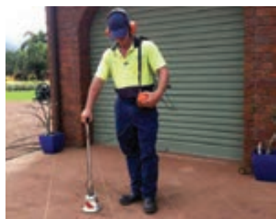
شکل ۱۰- تشخیص نشتی آب با دستگاه نشت یاب فراصوت ۱
