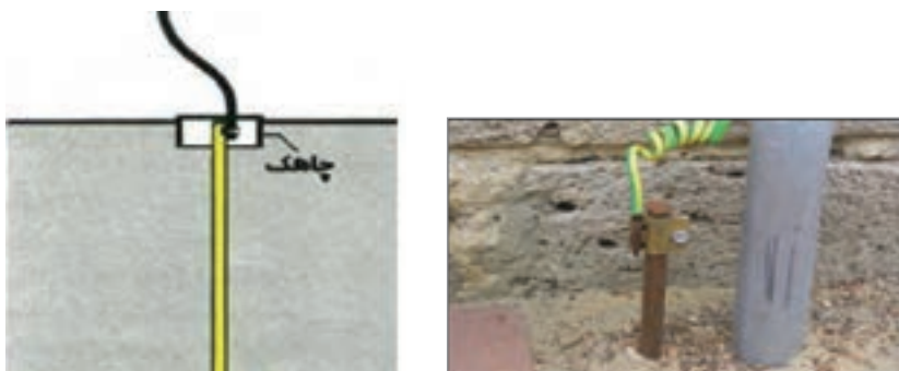
شکل ۴ - شیوه اتصال به چاه ارت
