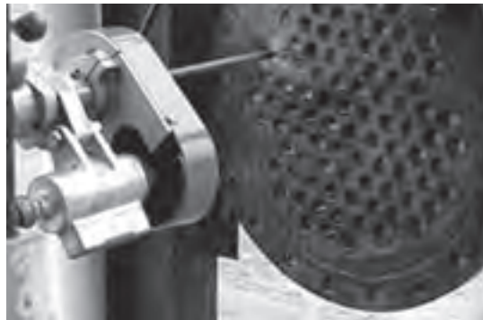
شکل ۲۱- دستگاه تزریق هیدروفورز مکانیکی
